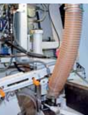
Bild 2: Spänerfassung 1 und 2 direkt am Sägeblatt
