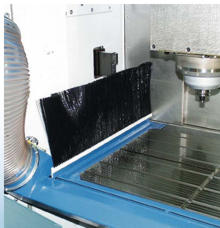
Patentiertes Tischabsaugsystem RSS1
