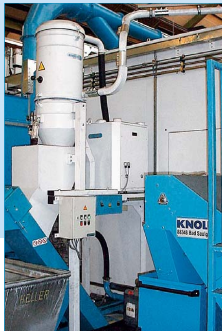
RA 240 D5,5 als Späneabsaugsystem mit 1 bis 2 Saugstellen
