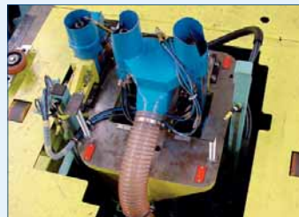
3 Saugstellen in die Fertigungsstraße einer Rohkarosserfertigung integriert
