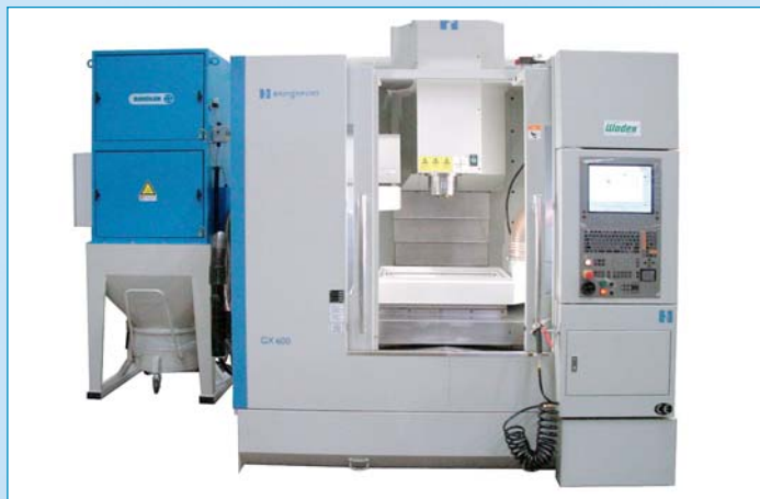
RE 201 an Bridgeport-BAZ GX 600 und Ringler-Tischdüse RSS1
