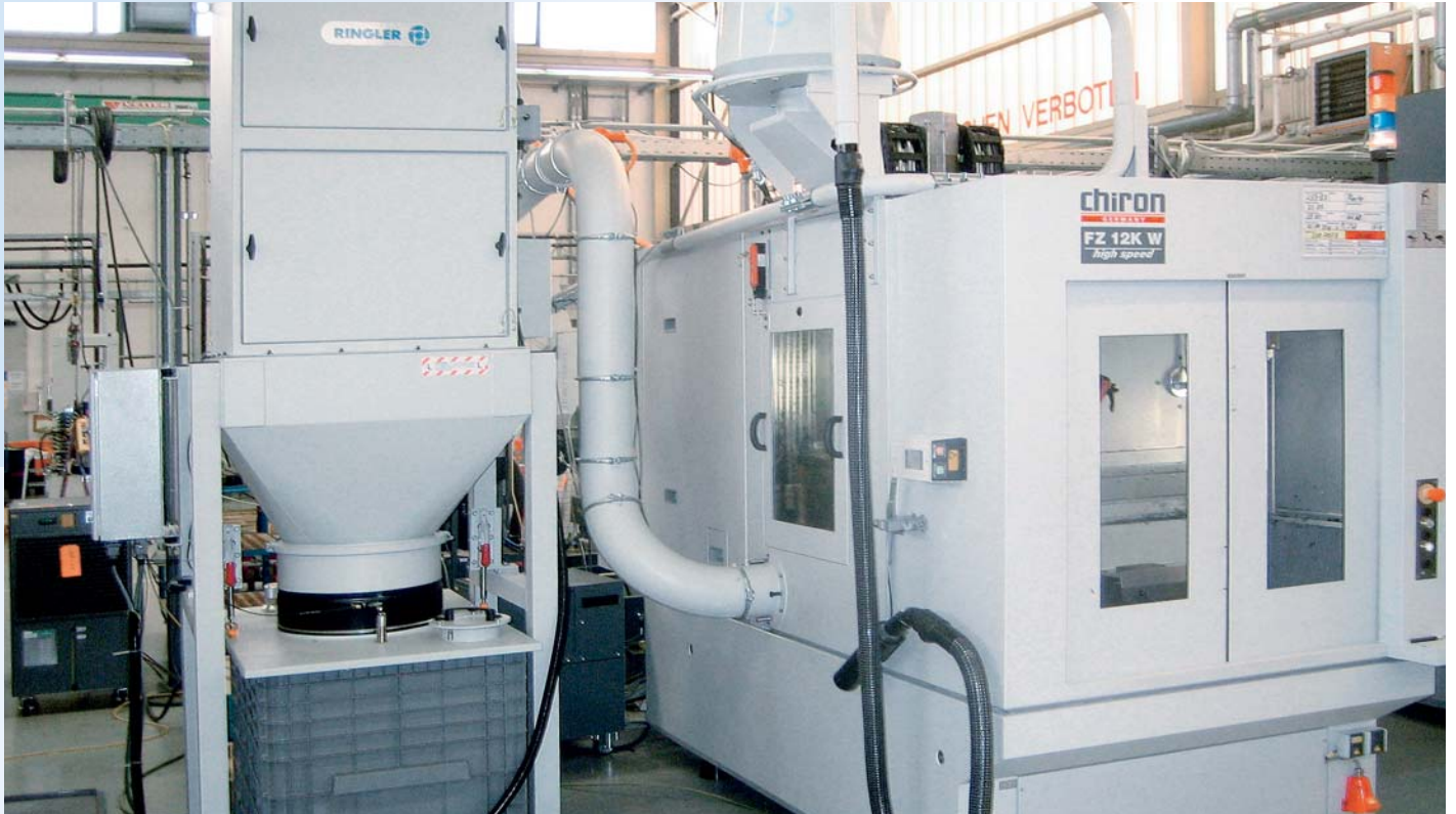
Absauglösung für die Erfassung von Kunststoffspänen: Ringler Entstauber RE 201 mit Chiron Bearbeitungszentrum FZ 12, mit automatischer Nass-/Trockenumschaltung, Handsaug Schlauch und Füllstandsüberwachung.
