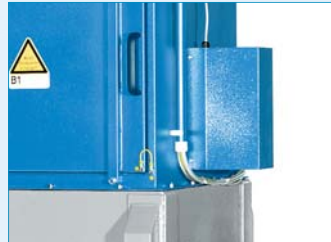
elektrischer Rüttelmotor für effiziente Filterabreinigung
