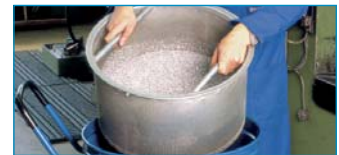
Siebkorb zum Trennen von Spänen und Flüssigkeiten (Kühlschmierstoffe)
