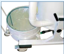
Staubarme Entleerung, Sammelbehälter mit PE Sack
