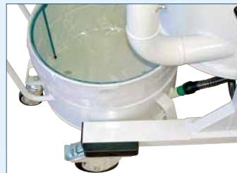
Staubarme Entleerung: ausfahrbarer Sammelbehälter mit PE Sack
