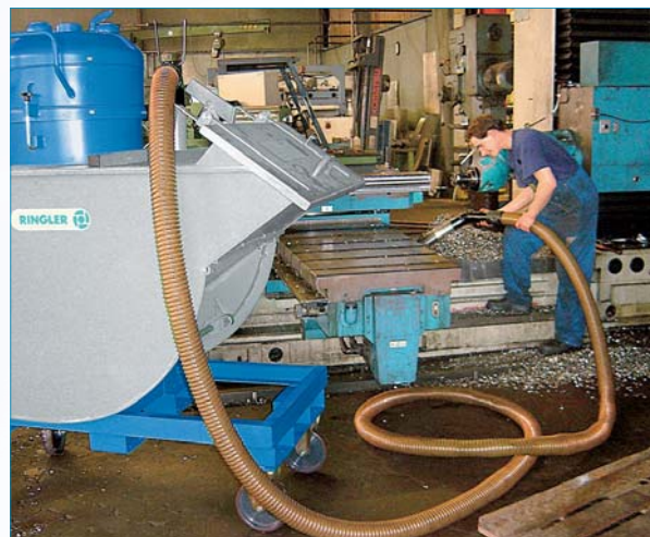
Absaugen großer Mengen Späne und Kühlschmierstoffe
